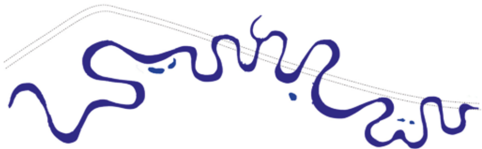
Abb. 3: Bachlauf vor (gestrichelt) und nach Baumsetzung (blau).
